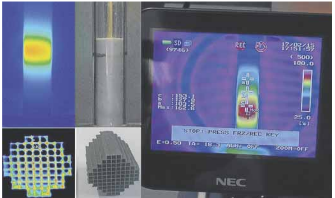
Los reactores estructurados contienen canales de dimensiones milimétricas donde se depositan los sólidos catalíticos. El calentamiento de las paredes del reactor se puede observar con una cámara termográfica. INA
