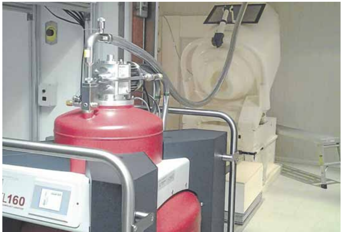
Licuefactor comercial ATL160 en el momento de trasvasar el helio recuperado y licuado, procedente de un magnetoencefalógrafo, en un centro de investigación médica en Munster (Alemania).
